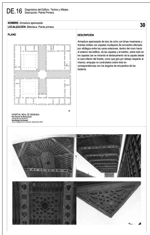
Fig. 9. Ficha de características constructivas de los techos del Hospital Real realizadas para el Plan Director del Hospital Real (2009)
