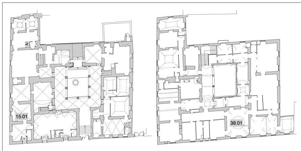
Fig. 1. Pianta del piano terra (a sinistra) e del piano primo (a destra) di palazzo Carli Benedetti, con la localizzazione di due dei prelievi effettuati. A piano terra il campione identificato con il numero 15.01 è una malta appartenente ad una muratura a filari sub orizzontali, riferibile alle precedenti schiere medievali. Nel piano superiore è stato prelevato un campione di malta, identificato con il numero 38.01, riferibile ad una muratura pertinente alle riparazioni successive al sisma del 1703, con paramento a filari alternati in mattoni e bozze calcaree (Tav. 3, p. 106).
